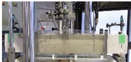
図4 液体に浸漬させた鉄筋コンクリートの曲げ疲労試験
